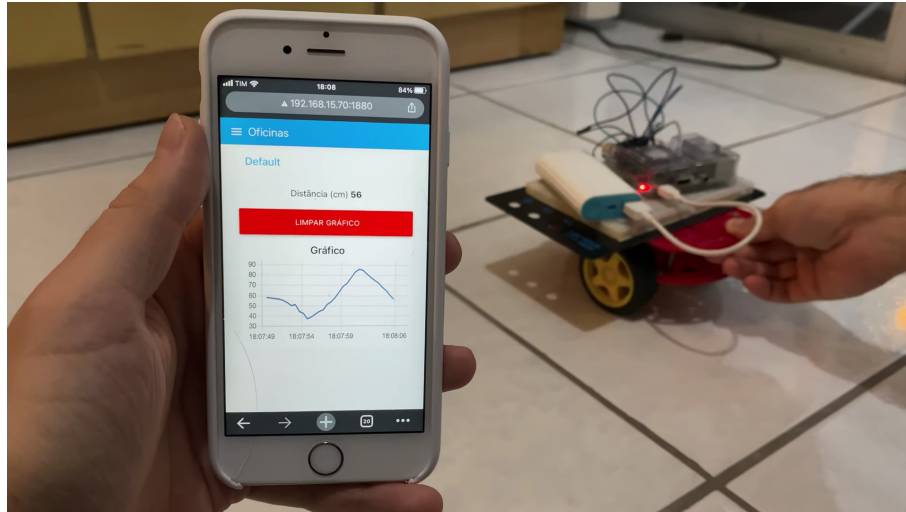
Figura 16: Testes de HW - Sensor ultrassônico
