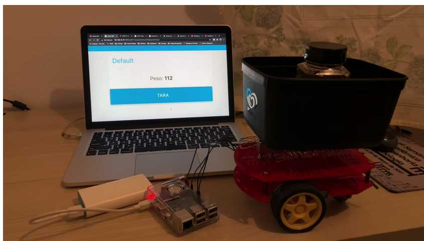
Figura 15: Testes de HW - Sensor de peso (módulo Hx711)
